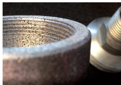
Bild 4. Lasttragende Schraubverbindung zwischen einem offenporigem Fillsert und einem Vollmaterial-Stutzen © Automoteam
