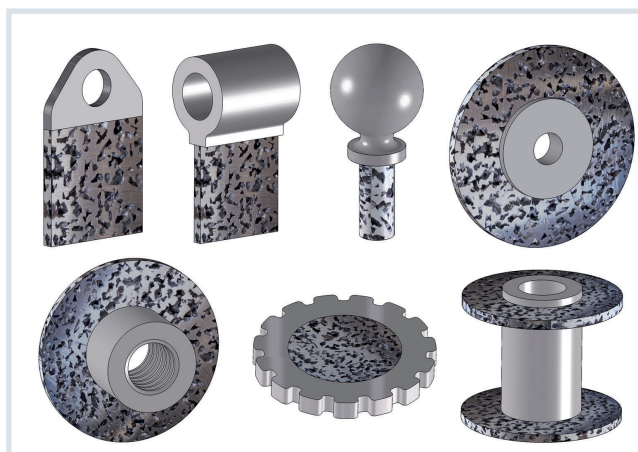
Bild 2. Durch Infiltration der offenporigen Strukturen (hier marmoriert abgebildet) mit Kunststoffen eröffnen sich neue Gestaltungsmöglichkeiten für Hybridbauteile © Automoteam
